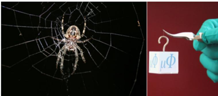
*Härtetest für Spinnenfäden: Ein Spinnenfaden - hier das Bild einer Kreuzspinne in ihrem Netz - ist einem Metalldraht gleicher Dicke in mancher Hinsicht überlegen. Nachdem Forscher des Max-Planck-Instituts für Mikrostrukturphysik ihn mit Metallionen infiltriert haben, hält der doppelt genommene Faden sogar einen 27,5 Gramm schweren Würfel, drei Mal mehr als ein natürlicher Faden.*
